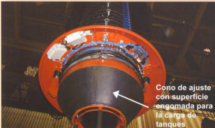
Cono de cierre con superficie antiabrasiva
